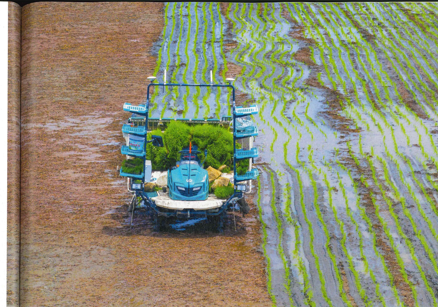
↑ Une repiqueuse de riz autonome sème des plants dans une rizière de Zhaohe, dans l'est de la Chine, en juin 2024.
